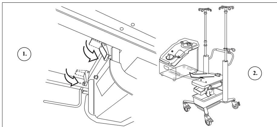
Figure 32, Retrait de l'appareil du chariot
