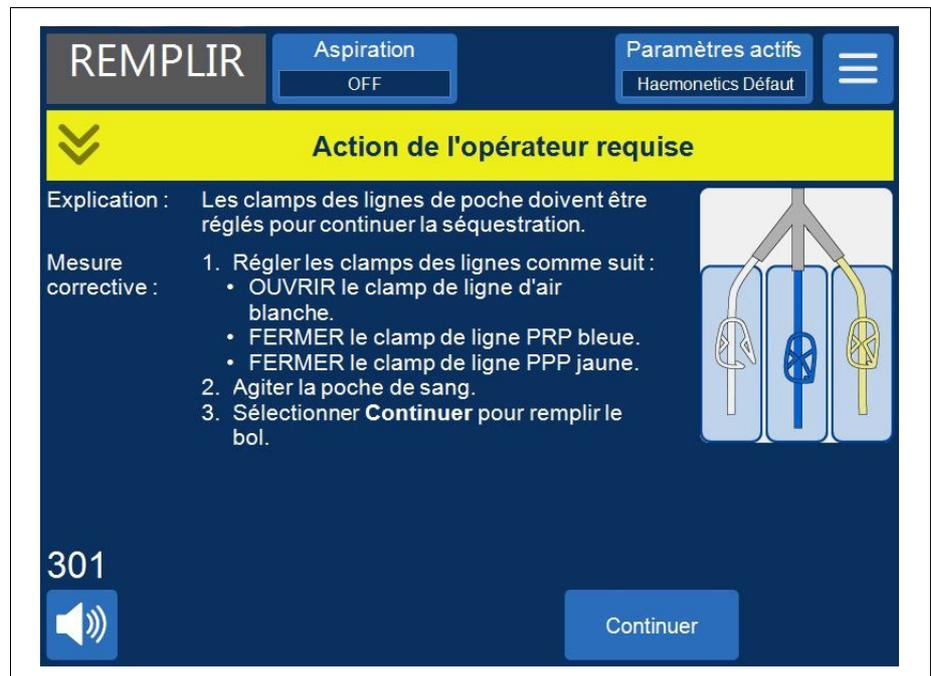
Figure 56, Exemple d'une invite de traitement de séquestration
