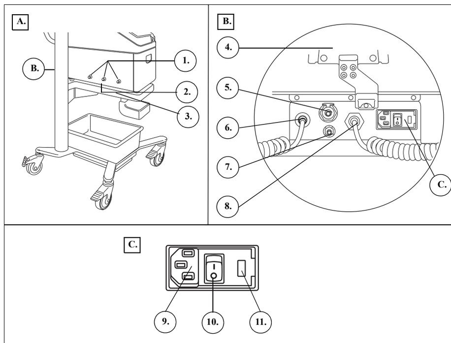
Figure 4, Composants des panneaux arrière et latéral
