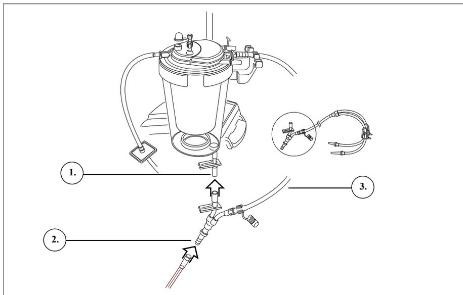
Figure 54, Faisceau d'adaptateurs de poche de sang
