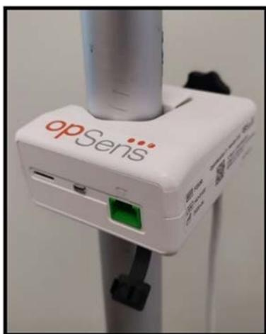
L'Unità Manipolo OptoMonitor 3 consente il collegamento tra il filo guida per pressione OptoWire™ e l'Unità Ottica. Anche l'Unità Manipolo è provvista di un LED sul lato anteriore, che fornisce diverse segnalazioni all'utilizzatore (vedere la sezione [3.6.2](#)).
