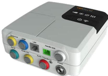
L'Unità Ottica calcola la pressione rilevata dal filo guida per pressione OptoWire™. L'unità principale fornisce i collegamenti al sistema emodinamico del laboratorio di cateterismo, al trasduttore aortico, all'Unità Display e all'Unità Manipolo. L'Unità Ottica è provvista di 6 LED sul lato anteriore, che forniscono diverse segnalazioni all'utilizzatore (vedere la sezione [3.6.2](#)).
